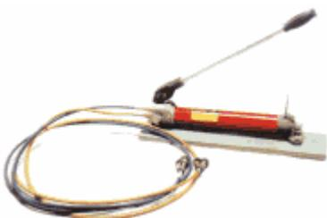
Насос ручной двухступенчатый является источником высокого давления, служит для подачи рабочей жидкости под давлением в гидравлический инструмент
