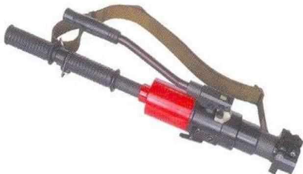
Предназначен для ведения аварийно-спасательных, ремонтно-строительных, монтажно-демонтажных, а также специальных работ. Шесть быстросменных насадок (разжим большой, разжим, разжим угловой, кусачки и ножницы) имеют возможность установки в четырех положениях, что позволяет выполнять работы в стесненных, труднодоступных местах. Встроенный автономный гидравлический привод обеспечивает надежное функционирование в любом пространственном положении и быстрый возврат инструмента в исходное положение.
